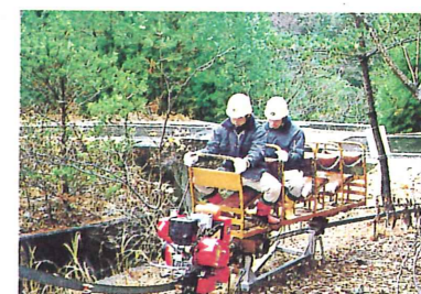
▲支柱打ち込み方式(平坦地・単軌条式乗用モノレール)
